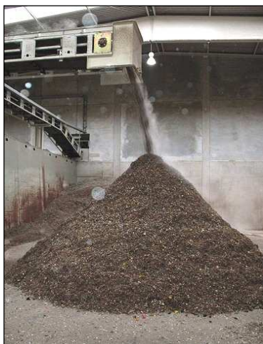
Exemple de Combustible solide de récupération avant expédition vers installation utilisatrice
